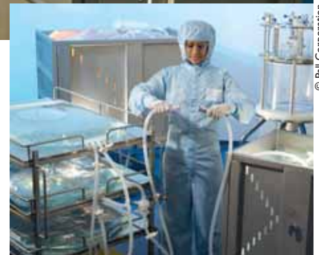
Prosessikomponenttien aseptinen liitäntä Kleenpak™ Connectorin avulla.
