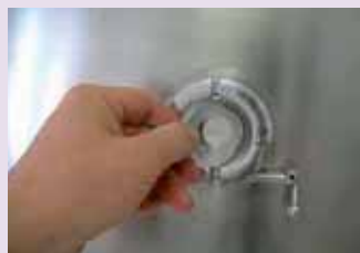
Avaa ruuvi. Aseta standardi TC tiiviste (silikoni, EPDM, viton tai PTFE) liittimen sisään.
