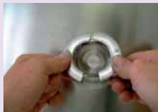
Löysennä mutteri ja avaa pikarengaan leuat täysin. Aseta rengas laippaan.
