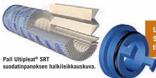
Pall Ultipleat® SRT UH311 -sarjan "servosuodatin" Liitännäkoko 1 1/4, 1 1/2 tai 2" Käyttöpaine aina 420 bar asti Suodatinpatruunan paine-ero 210 bar asti Maks. virtaus 700 l/min
