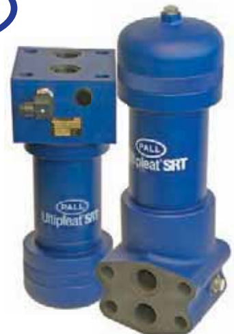
Pall Ultipleat® SRT UH319 -sarjan painesuodatin Lohkoliitännät 1 1/4" sivulta tai päältä Käyttöpaine aina 420 bar asti Maks. virtaus 600 l/min
