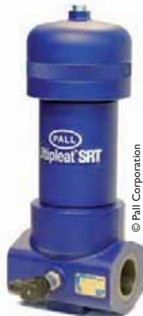
Pall Ultipleat® SRT UH311 -sarjan "servosuodatin" Liitännäkoko 1 1/4, 1 1/2 tai 2" Käyttöpaine aina 420 bar asti Suodatinpatruunan paine-ero 210 bar asti Maks. virtaus 700 l/min
