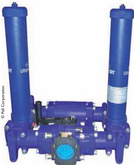
Pall Ultipleat® SRT UR329 Duplex-sarjan suodatin, liitännäkoko 3" Käyttöpaine 28 bar Maks. virtaus 600 l/min
