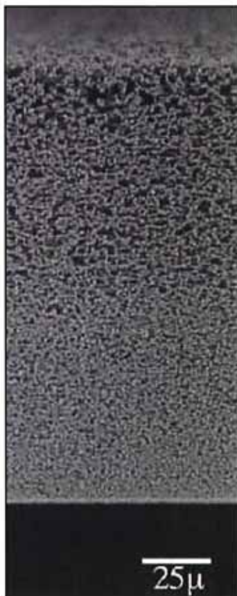
Asymmetriset polyetersulfonimembraanit (PES) ovat edistäneet merkittävästi suodattimien suorituskykyä. Keskimäärin 3 → 1 huokoskoon muutos läpi membraanin syvyyden antaa isomman huokoisuusominaisuuden ja paremman lianpidätyskapasiteetin.
