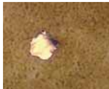
Kuva 1. Yli 20 µm kokoisten metallihiutaleiden ja liukenemattoman öljysakan ilmaantumisen viittaavat heikentyneeseen voitelukykyyn.
