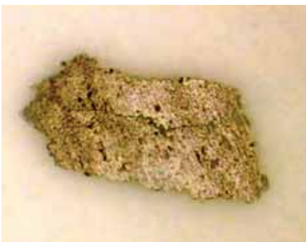
Metallihiukkasen koko ja muoto antavat viitteitä kulumismekanismista sekä kulumisen voimakkuudesta.
