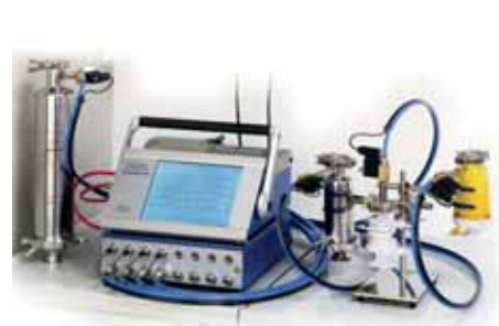
Kuva 5. Pall Flowstar: Edistyskelliset kaasus- ja nestesuodattimien eheydentestauslaitteet sekä neste- että kaasusuodattimille.
