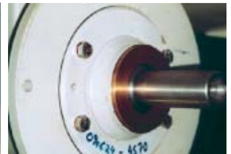
Pumpun laakerointi Inpro-tiivisteellä.
